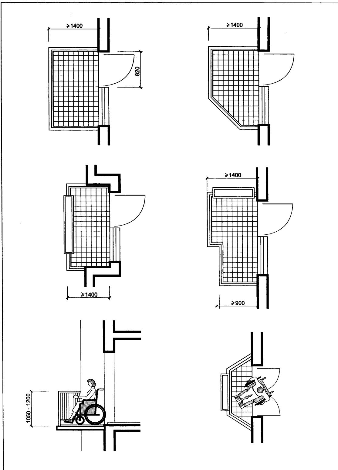
"Рисунок 5.10. Планировка балконов и лоджий"
