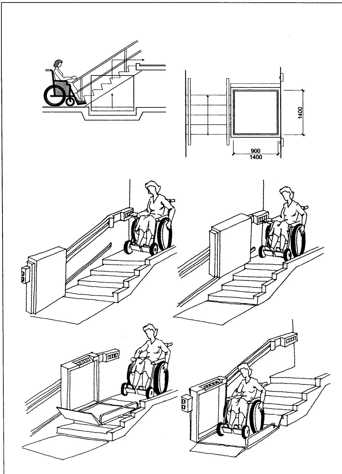
"Рисунок 4.2. Варианты устройства подъемников",
