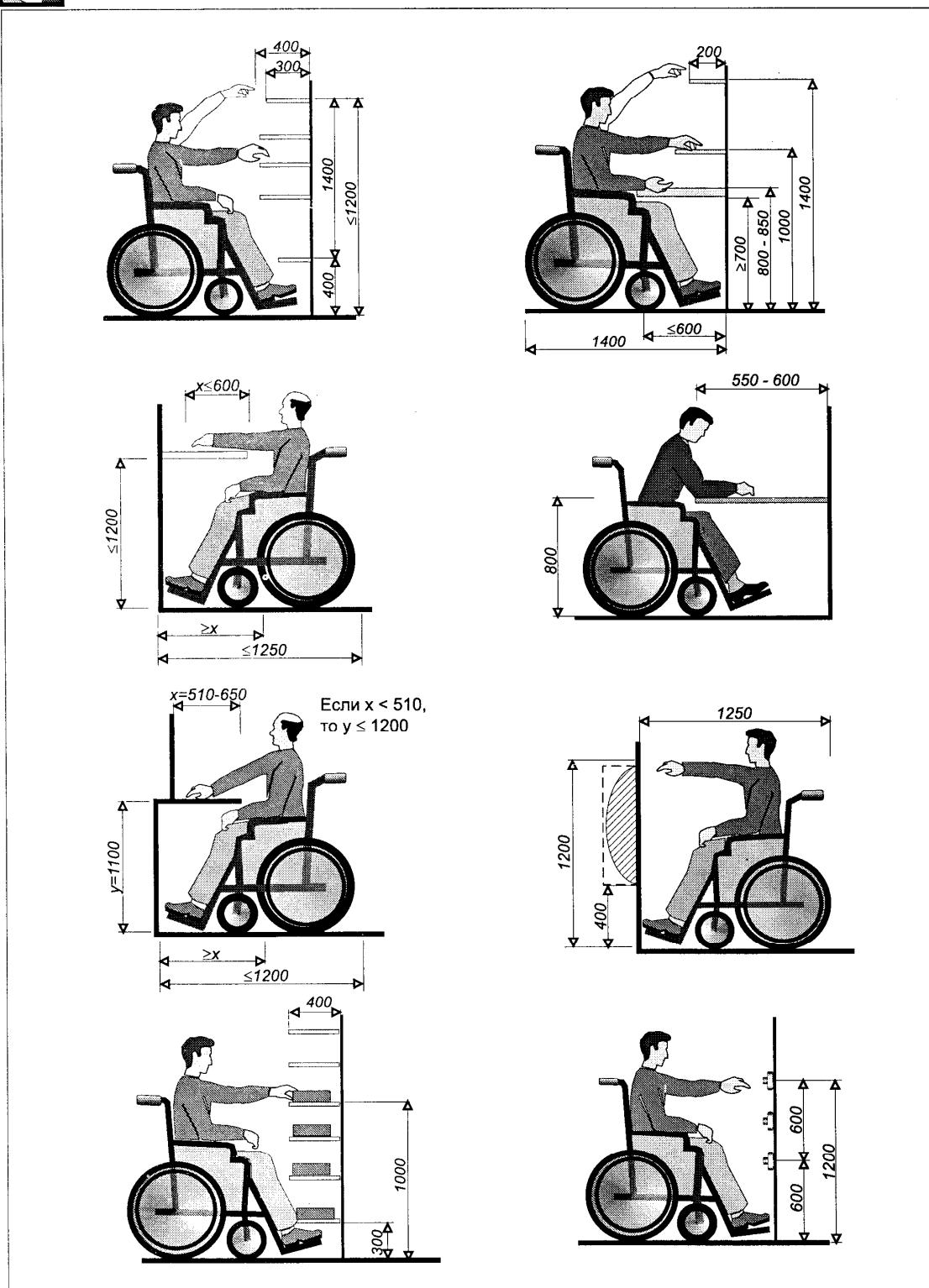
"Рисунок 3.4. Параметры досягаемости при фронтальном доступе
