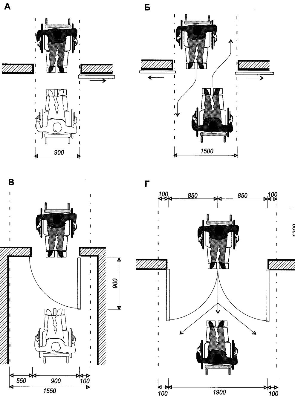
Минимальные габариты свободных площадок с обеих сторон дверного проема раздвижных однопольных (А) и двупольных (Б) дверей, распашных однопольных (В) и двупольных (Г) дверей
