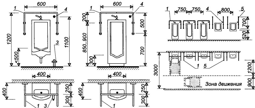
1 — поручни опоры; 2 — смывной кран (ручной); 3 — смывной кран (ножной);
