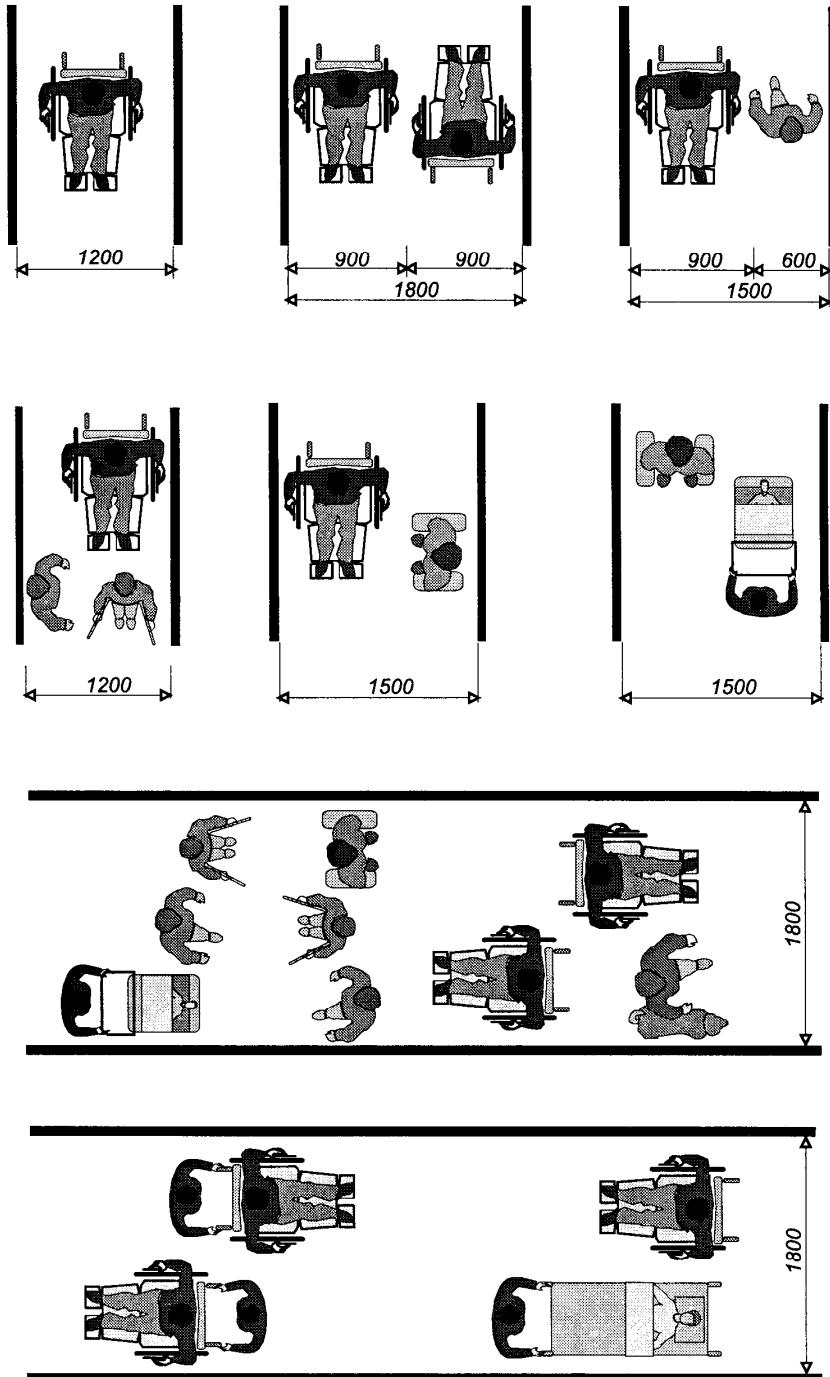
"Рисунок 2.6. Пропускная способность коридоров"
