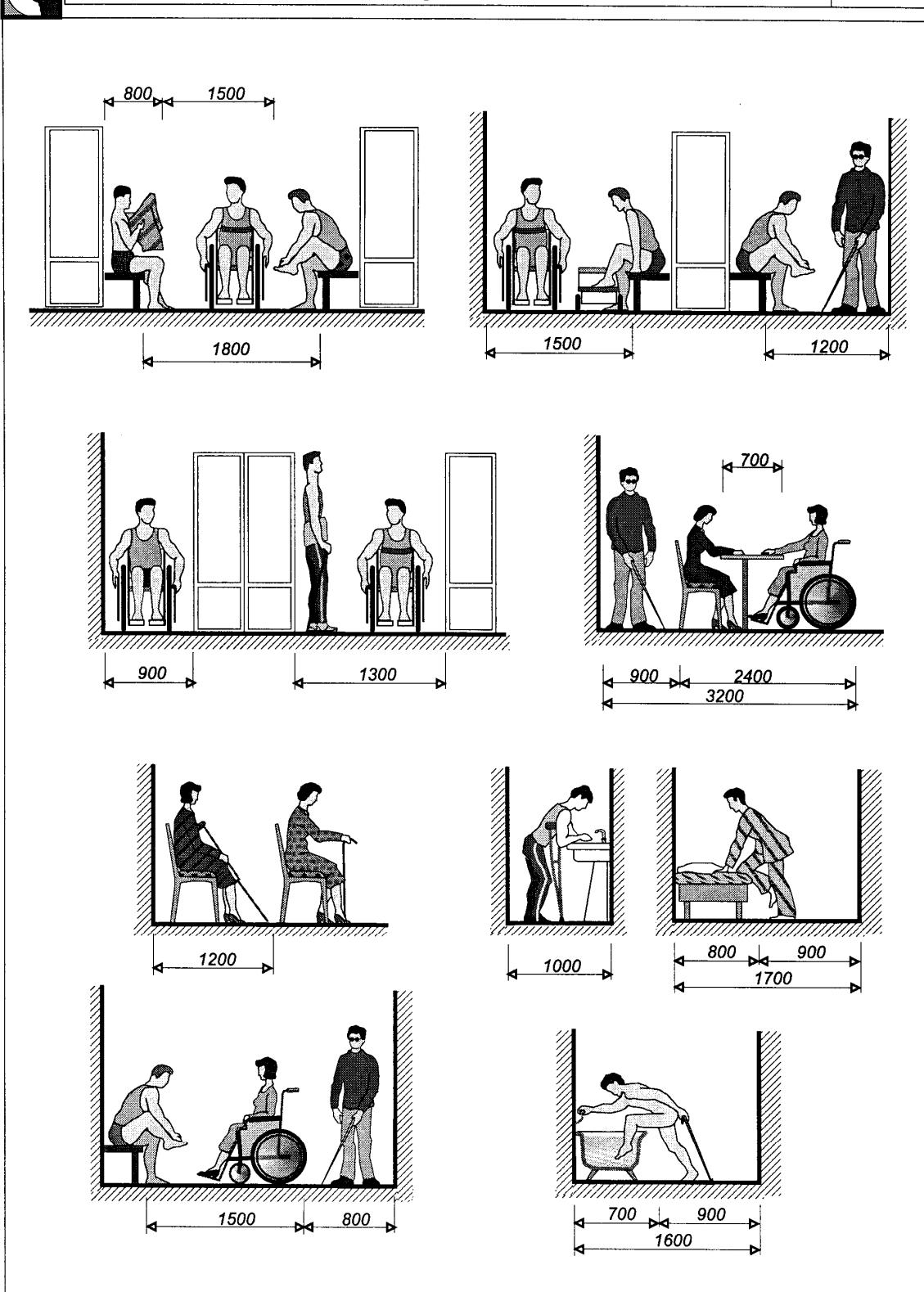
"Рисунок 3.7. Параметры функциональных зон"
