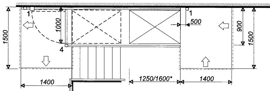
"Рисунок 2.28. Параметры наклонных подъемников"
